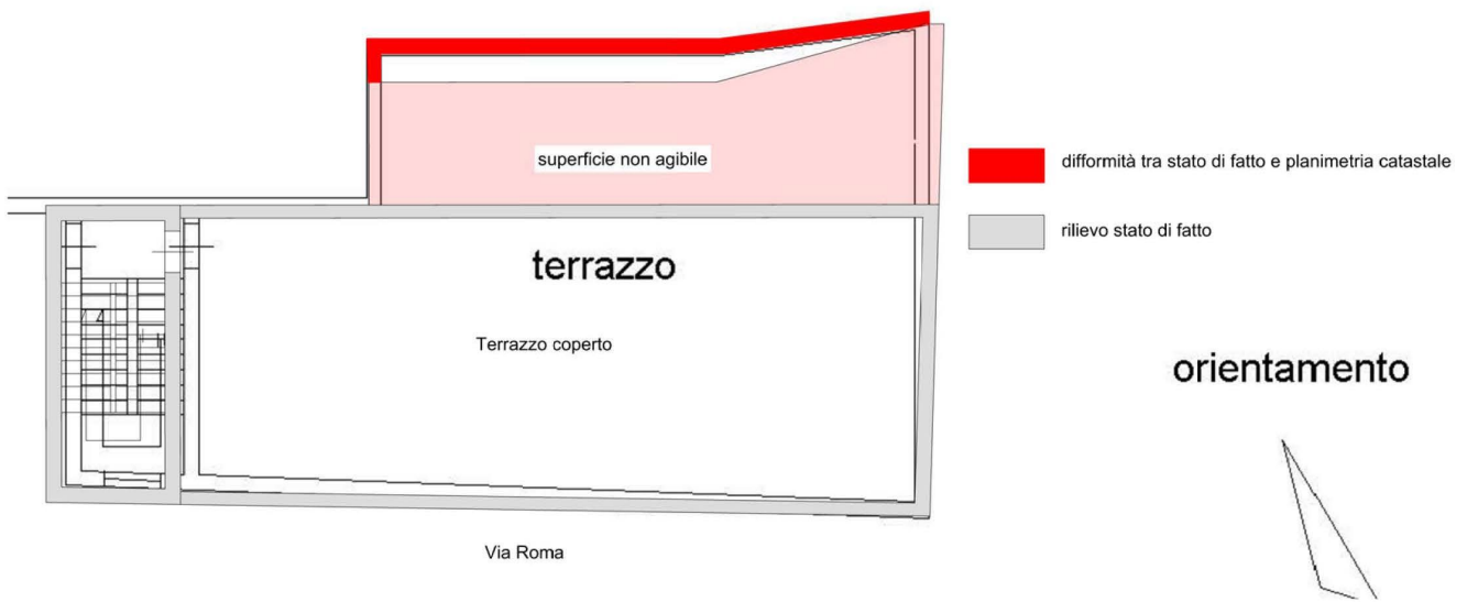
Sovrapposizione dello stato di fatto da rilievo del terrazzo del V piano con la planimetria catastale
