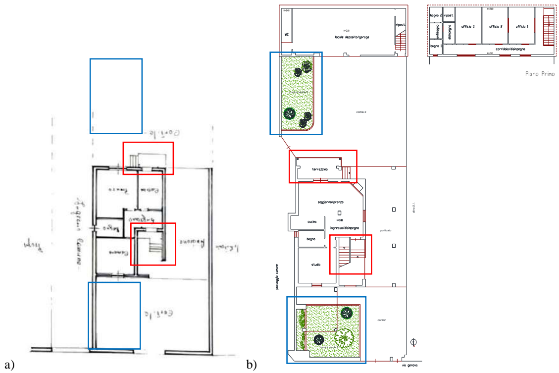
Figura 1: piano terra: a) Planimetria del titolo abilitativo; b) Planimetria stato di fatto
