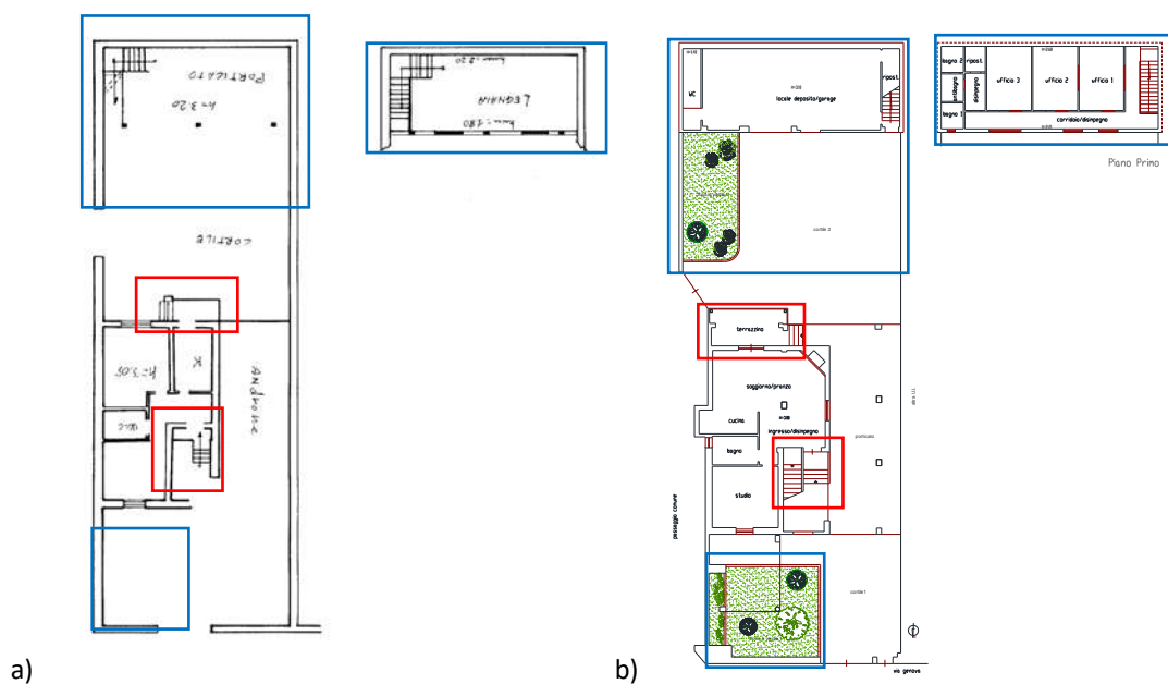
Figura 31: piano terra-piano rialzato: a) planimetria catastale; b) planimetria stato di fatto
