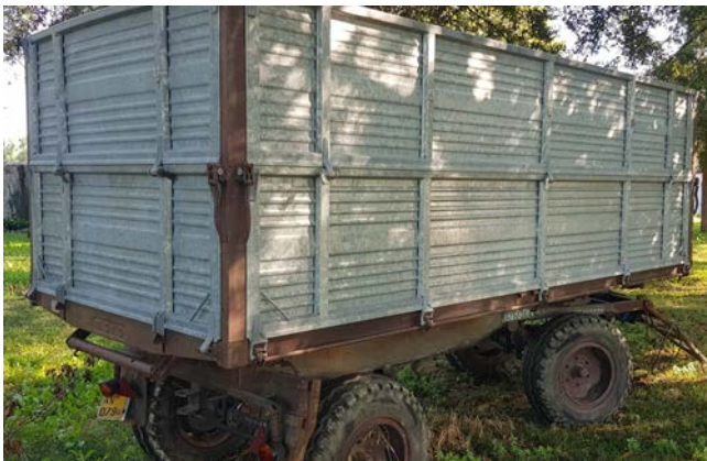
18 Rimorchio agricolo due assi Moro targato TV13670 immatricolato il 01.03.1979 con libretto UMA. Ribaltabile su tre lati a doppia sponda alta 120 cm. Con presa di potenza
