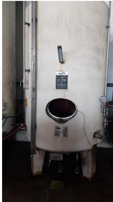
66 B-C-D autoclavi per spumantizzazione capacità 25 hl, le prime due in ferro smaltato
