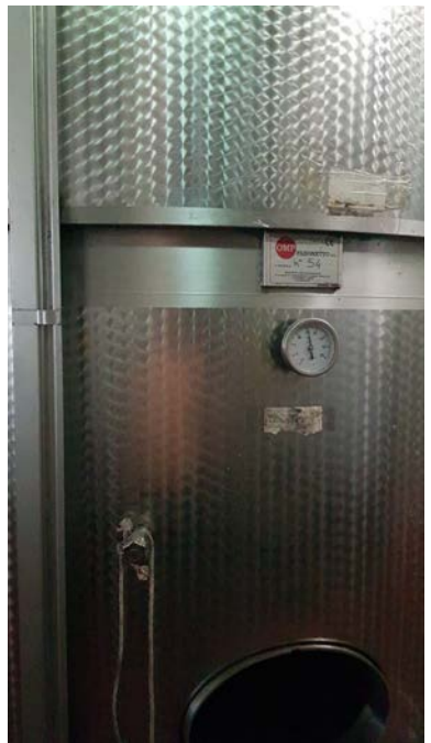
60 A-B vasche inox refrigerate a glicole con doppia parete per cooling, capacità 150 hl
