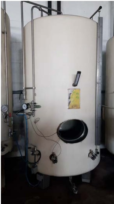
66 B-C-D autoclavi per spumantizzazione capacità 25 hl, le prime due in ferro smaltato
