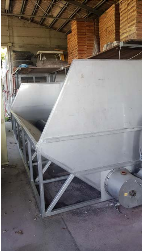
26 Vasca di raccolta uve. In acciaio inox con pompa incorporata, lunghezza 6 m. Anno di fabbricazione 2011. matricola 1235/11. Marchiata CE
