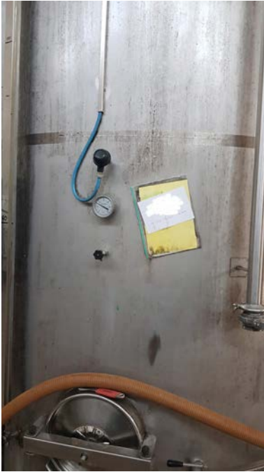
32 A-B-C: Vasche in acciaio inox refrigerate. Sistema cooling a biscotto con glycole. Capacità 250 hl ciascuna. La 32C ha tasche di raffreddamento (non coibentate), fondo conico con estrazione a pale automatica e irroratore per i rimontaggi, per vinificazione
