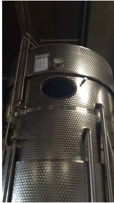
58 A-B-C-D n.4 vasche inox refrigerate a glicole con doppia parete per cooling, capacità 25 hl
