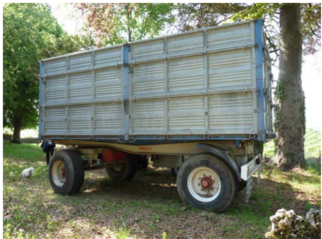
19 Rimorchio agricolo due assi Pavelli targato TV23634 immatricolato il 16.04.1996. Cassone ribaltabile su tre lati a doppia sponda h 150 cm. Con presa di potenza. Portata 140 q
