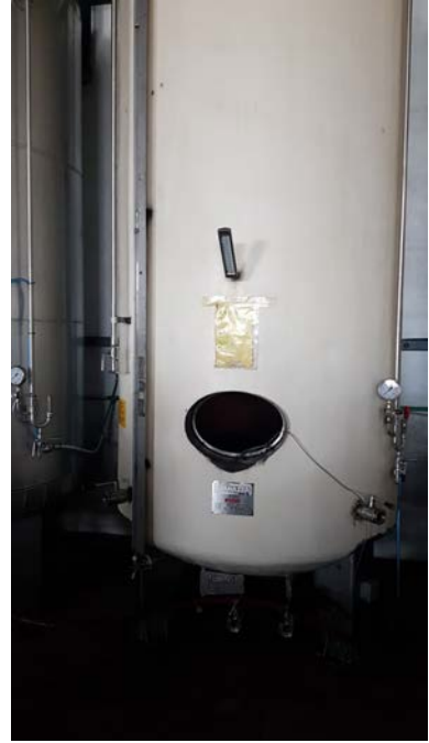
65 A-B autoclavi per spumantizzazione in ferro smaltato capacità 50 hl
