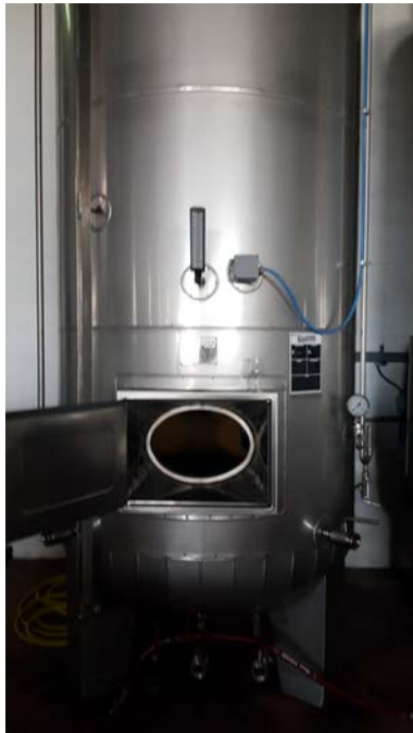
65 C-D autoclavi per spumantizzazione capacità 50 hl
