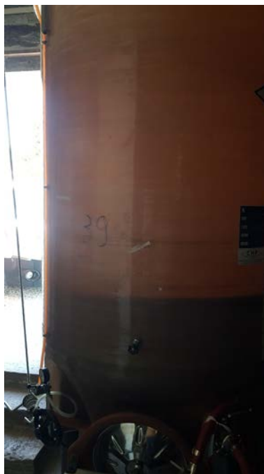
4 A-B-C-D-E : vasche in vetroresina per alimenti con sistema troppopieno, capacità 45 hl le prime quattro, capacità 30 hl l'ultima ("39" nella foto).
