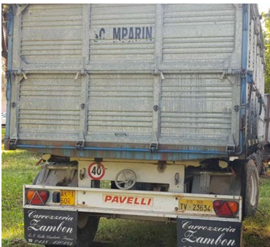
19 Rimorchio agricolo due assi Pavelli targato TV23634 immatricolato il 16.04.1996. Cassone ribaltabile su tre lati a doppia sponda h 150 cm. Con presa di potenza. Portata 140 q
