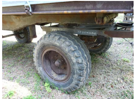
18 Rimorchio agricolo due assi Moro targato TV13670 immatricolato il 01.03.1979 con libretto UMA. Ribaltabile su tre lati a doppia sponda alta 120 cm. Con presa di potenza
