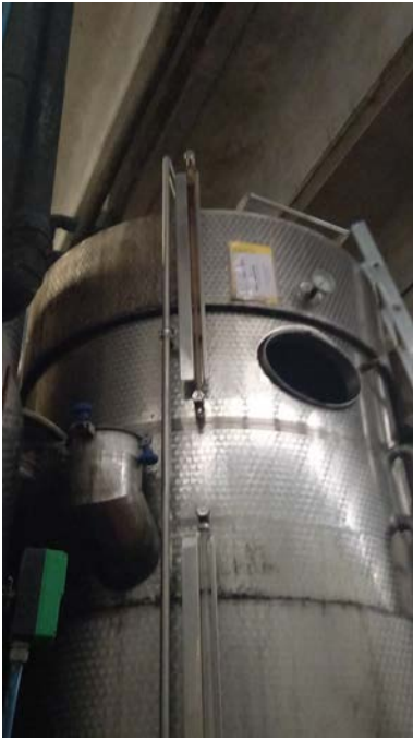
58 A-B-C-D n.4 vasche inox refrigerate a glicole con doppia parete per cooling, capacità 25 hl
