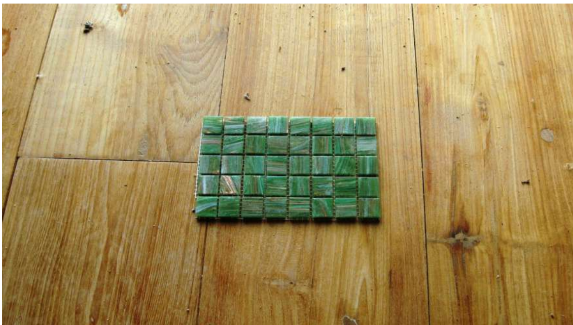
Foto n.22: vista dettagliata dei materiali di rivestimento di pregio utilizzati negli immobili A, B e C. Listoni di parquet per le pavimentazioni e tasselli di mosaico per i servizi.
