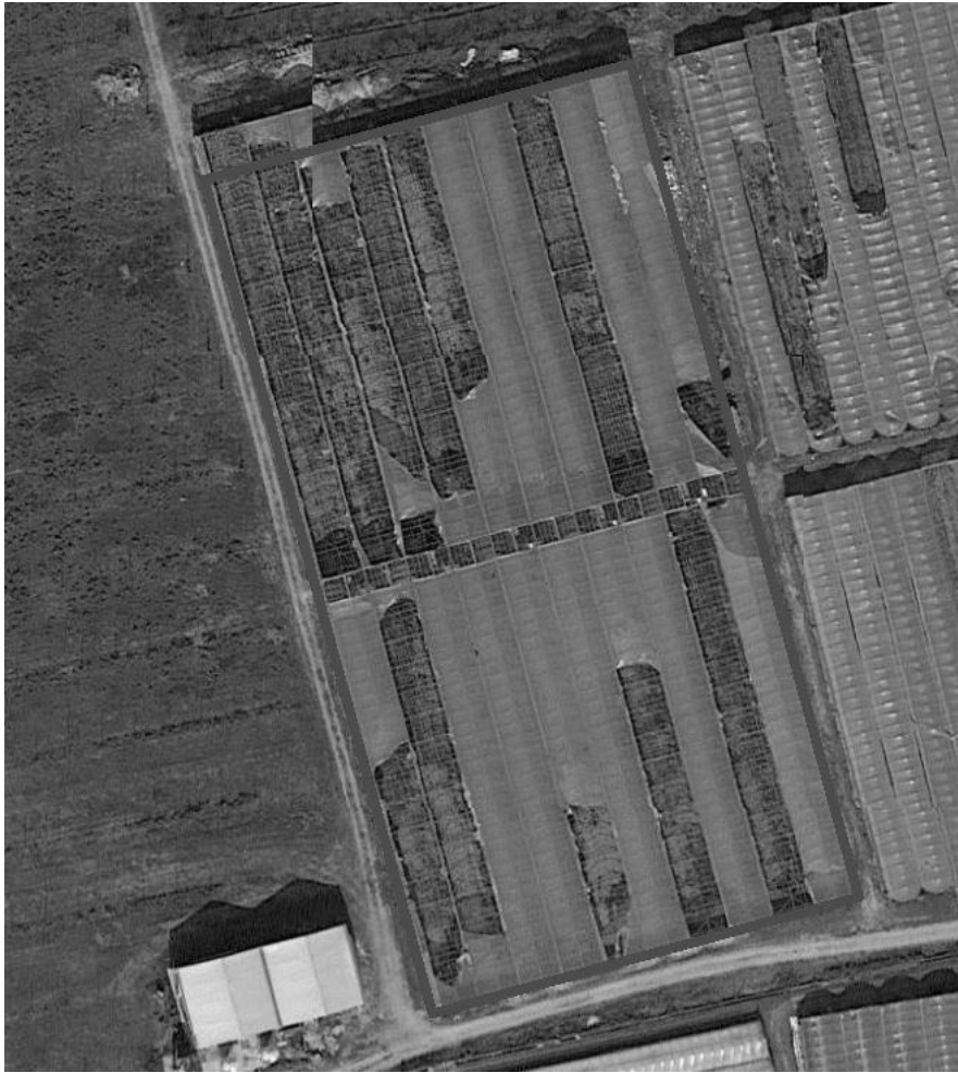
Vista satellitare del mapp. 883 CEU-CT fg. 40 Comune di Villafranca di Vr dove è presente una serra con coperture fortemente deteriorate e riprese fotografiche effettuate nel corso del sopralluogo
