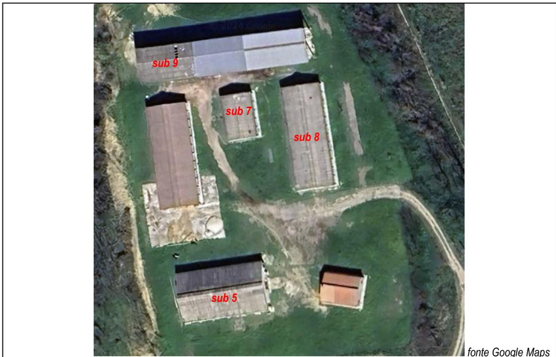
I suddetti manti di copertura, costituiti da lastre di cemento amianto, sviluppano una superficie totale di circa 1.800 mq.
