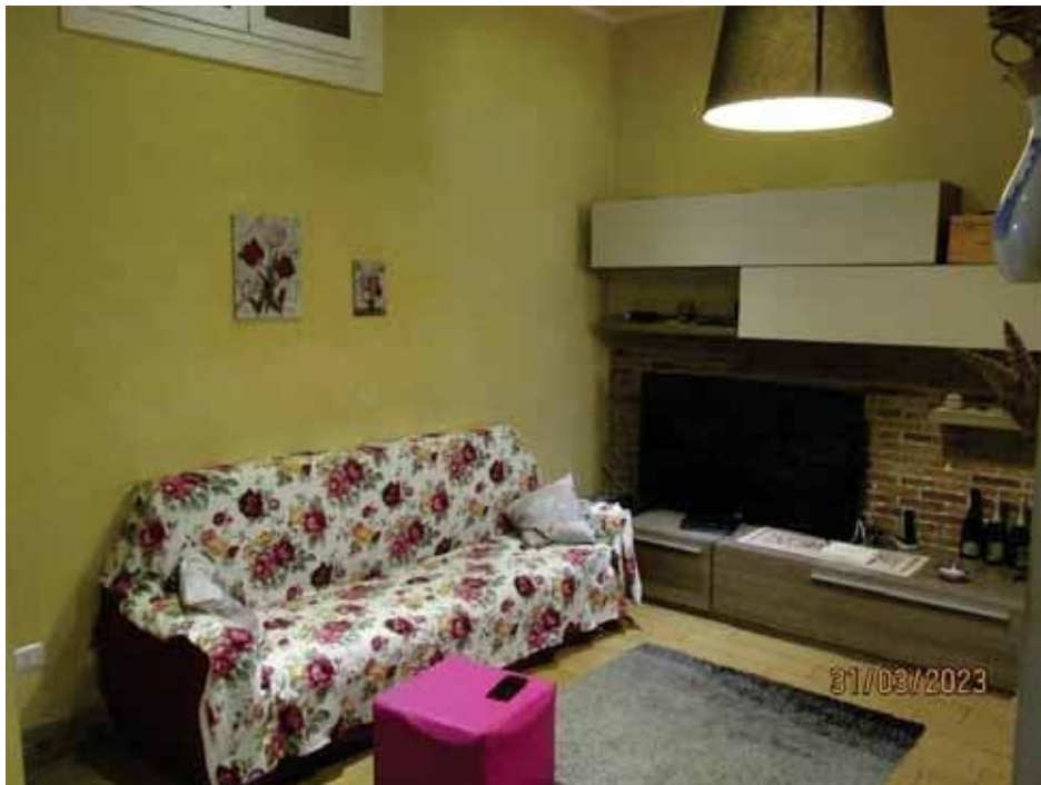
Fotografia 18 – Vano 1: È interamente pavimentato con piastrelle in gres porcellanato, presenta le pareti intonacate e tinteggiate con pittura lavabile ad eccezione dell'angolo TV che è rivestito con mattoncini rossi in modo da formare una zoccolatura bassa alla parete, nella quale è incassato un termocamino con sottostante mobile basso. Il soffitto dell'intero ambiente è rivestito con intonaci ordinari a finitura liscia e tinteggiato con pittura a tempera.
