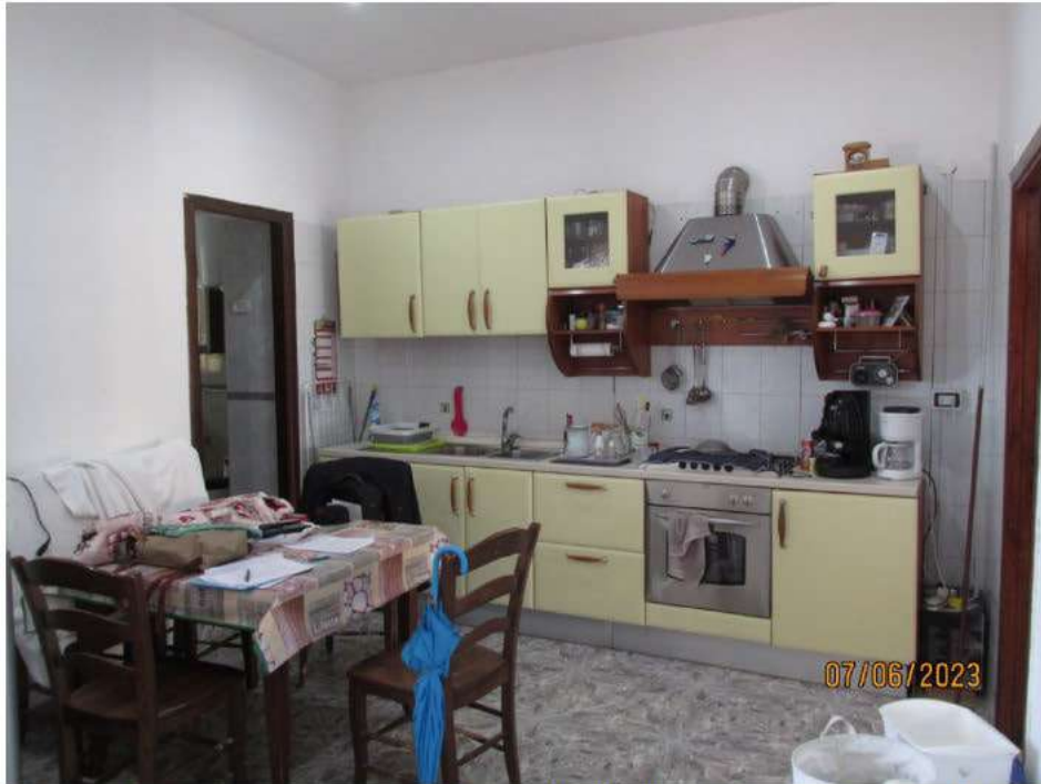
Fotografia 20 – Soggiorno/Cucina: le pareti sono rivestite con intonaci ordinari a finitura liscia e tinteggiate con pittura lavabile, ad eccezione dell'angolo cottura che risulta rivestito con piastrelle in ceramica smaltata per un'altezza di circa ml 2,10; il soffitto è rivestito anch'esso con intonaci ordinari a finitura liscia e tinteggiato con pittura a tempera, il tutto in discreto stato di conservazione.
