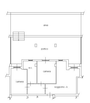
PIANTA PIANO TERRA H=2.70m
