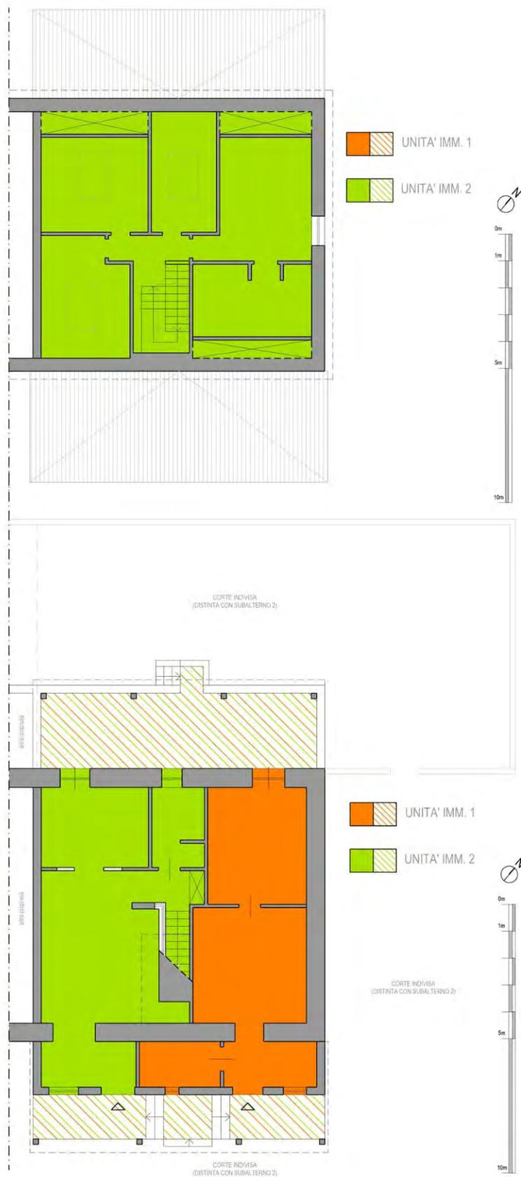
Fig. 7 - Indicazione grafica delle due sub-unità ricavate nel Sub. 1 P.IIa 35, su base rilievo all'attualità PT (sotto)/P1(sopra) - vedi Allegato n°9 RILIEVO METRICO fabbricato
