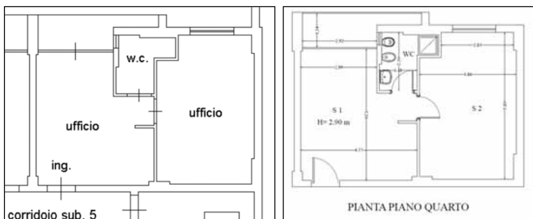
Fig. 5 – Confronto della Planimetria in atti al Catasto con lo stato dei luoghi - CONFORME
