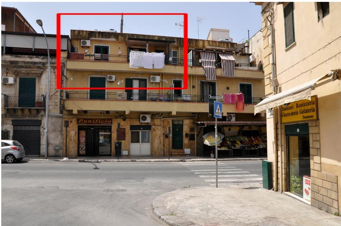
terra e primo) e successivamente ampliata con cordoli di rinforzo e strutture portanti intelaiate in c.c.a, solai interpiano misti in ferro, cemento e laterizio, murature di tompanamento e tramezzatura in blocchi di tufo e/o cemento pomice.
