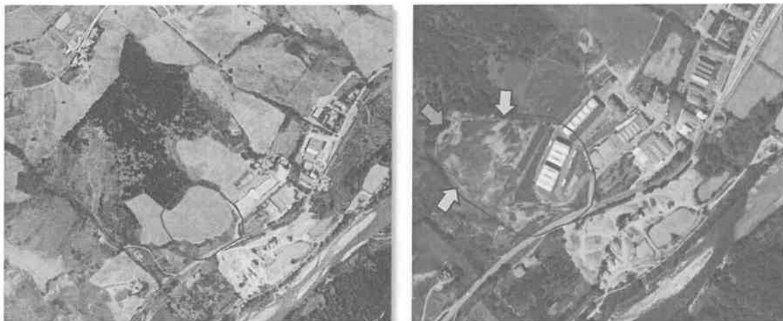
Figura 12 – Sinistra: Volo Italia 2000; destra: ortofoto del Ministero dell’Ambiente (2006) – Le due immagini evidenziano in modo chiaro la modificazione morfologica del pendio conseguente all’evento franoso sismoindotto del settembre 2003. Se nel 2000 la situazione morfologica era ancora identica ai decenni precedenti (1954-1994), dopo soli tre anni dall’evento franoso sono ancora ben chiare le forme create dall’evento stesso: la scarpata di distacco principale (con l’orlo indicato dalla freccia azzurra), i fianchi laterali (indicati dalle frecce gialle) e ampie zone distribuite sul corpo di frana, prive di vegetazione.
