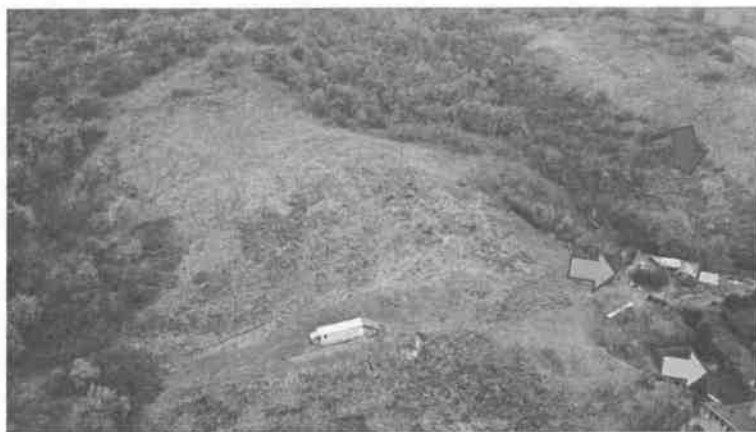
Figura 18 – Zona C – la freccia azzurra indica l'ex lago, poi palude ed ora superficie occupata da elementi antropici; la freccia rossa indica la frana attiva a monte dell'ex palude; la freccia verde indica l'area un tempo occupata dalla conoide di deiezione ed oggi adibita a giardino delle abitazioni presenti (foto drone: 20/11/2025).
