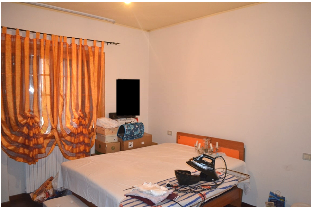
foto 6 – m.n. 378 sub 1 (letto 3) – È l'unica stanza da letto senza balcone, ma ciononostante rimangono l'omologazione a camera matrimoniale e un rapporto aeroilluminante superiore all'ottavo (qui vale 0.148). Tutta la zona notte ha altezza utile netta di 2.98m, leggermente maggiore di quella misurabile nella parte ribassata dell'appartamento (2.96m). Anche qui il corpo illuminante è a centro soffitto.
