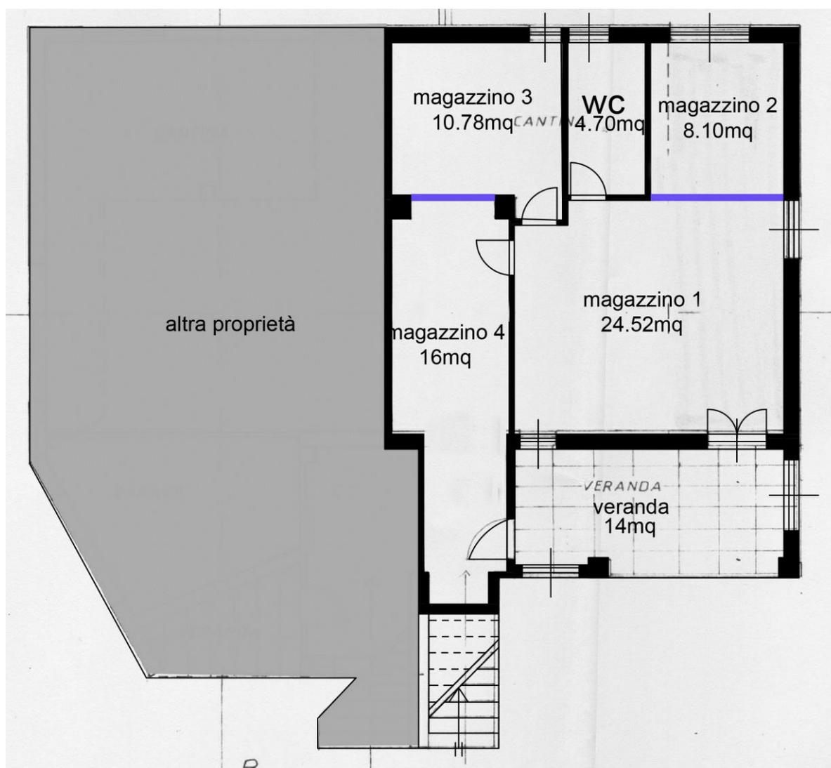
Planimetria piano seminterrato con i due setti da demolire per ripristinare i 3 locali autorizzabili
