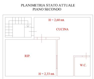
Ambienti da demolire in quanto abusivi compreso il tetto in pannelli coibentati il tutto necessario per ripristinare la copertura a terrazzo, tranne il torrino scala
