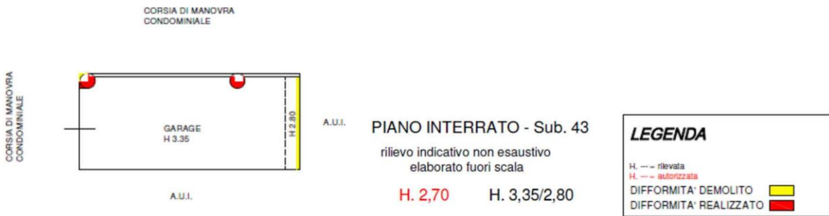
Figura 9.b Comparazione stato attuale – stato rilevato autorimessa sub. 43.
