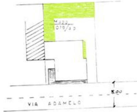
in verde le opere abusive su spazi comuni condominiali
