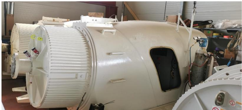
1. Smontaggio del rotore e pale per verifica esistenza danni strutturali (es. da fulmini o eventi atmosferici eccezionalmente violenti)
