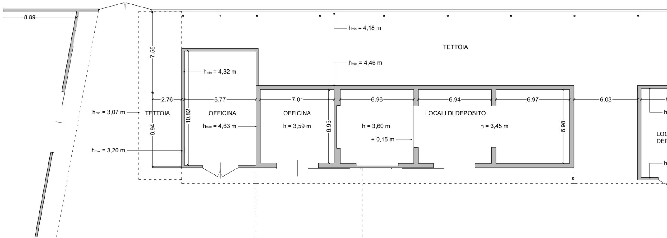
PIANTA PIANO TERRA\_2 TETTOIA\_3 OFFICINA\_4 LOCALI DI DEPOSITO\_5 TETTOIA
