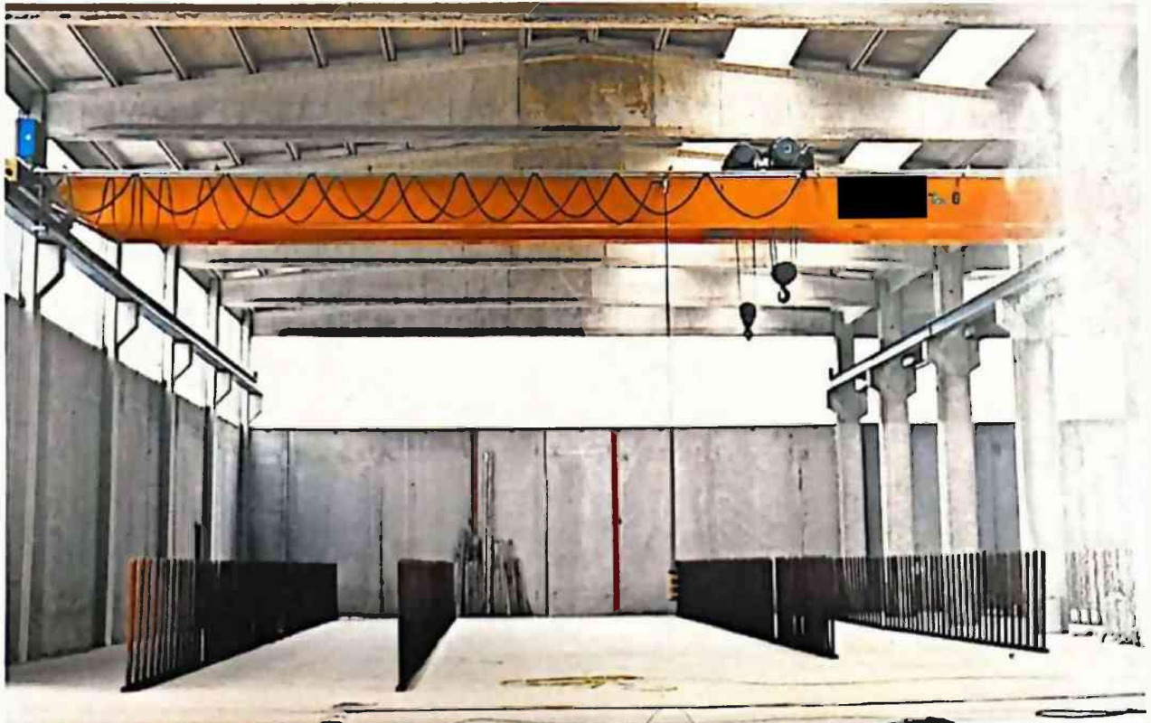
GRU BITRAVE - PORTATA PRINCIPALE TON. 6 - PORTATA AUSILIARIA TON. 2
