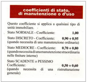
Figura 3 - coefficienti di stato, manutenzione d'uso, ricavati da rivista di aggiornamento professionale del Collegio Geometri della Provincia di Belluno, Rovigo, Treviso e Vicenza
