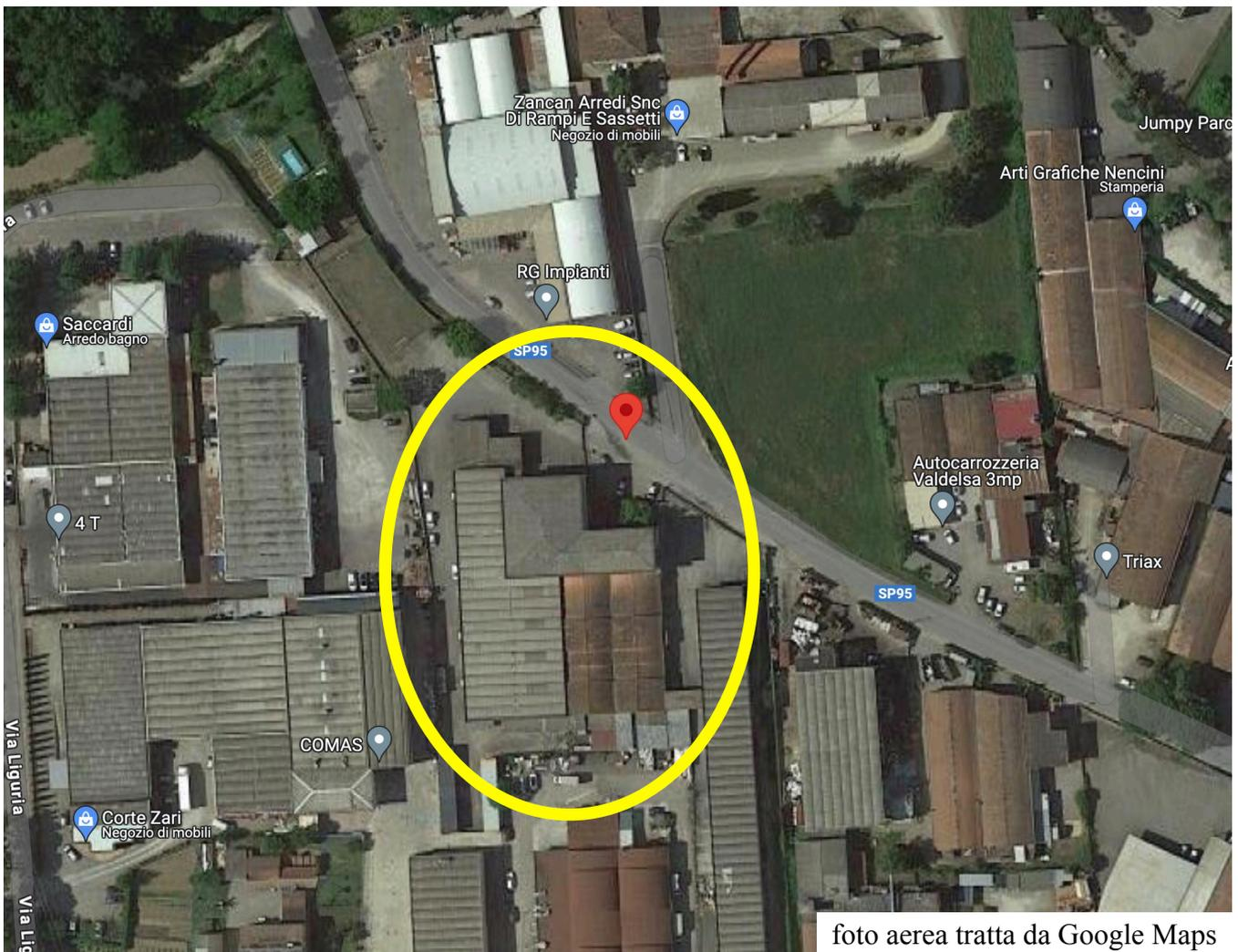
I vari ambienti presentano coperture diverse sia per materiali che per tipologia: la zona ufficio, ripostigli e centrale termica, a nord-ovest, presentano un tetto piano incatramato, la parte del laboratorio ad est, più vecchia, ha una copertura a volte paraboliche in laterizio e c.a. prefabbricato con tiranti in ferro, la parte di laboratorio ad ovest, ricostruita dopo l'incendio del 1994, presenta copertura del tipo piano con travi di cemento armato
