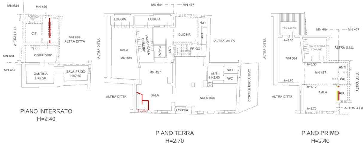
Dal rilievo sul posto si riscontrano discrepanze rispetto le planimetrie catastali depositate, a seguito di lavori edili in buona parte autorizzati. Pertanto **le planimetrie NON risultano conformi allo stato dei luoghi** e necessitano una pratica di aggiornamento per un costo stimato di circa 600€.
