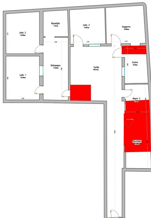
3. Realizzazione della muratura di confine del cortile privato – Il cortile Interno è stato coperto con una struttura in legno. Un'ulteriore struttura in vetroresina e legno completa la copertura della porzione di cortile rettangolare. Tale struttura partecipa al superamento della superficie massima di copertura ben oltre la tolleranza del 2%.
