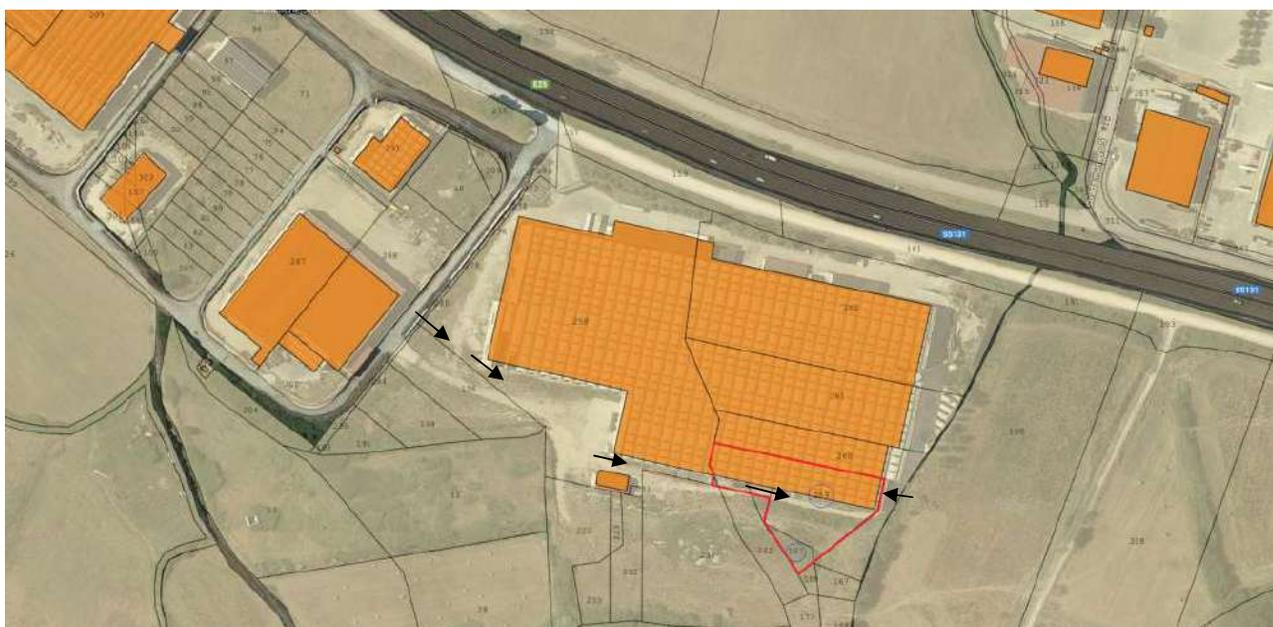
Foto n. 4: Accesso all'area con realizzazione di strada di piano e servitù di passaggio su particella 258
