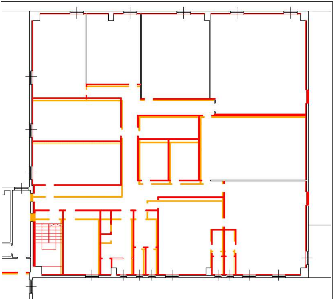
Stralcio della zona uffici del piano primo con i muri perimetrali dello spessore di 30cm, anziché i 20cm da progetto.
