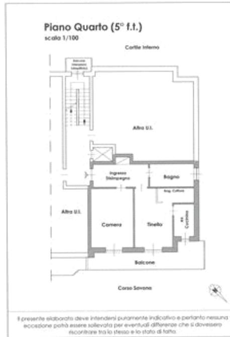
PIANTA DELL'ALLOGGIO - Stato di fatto
