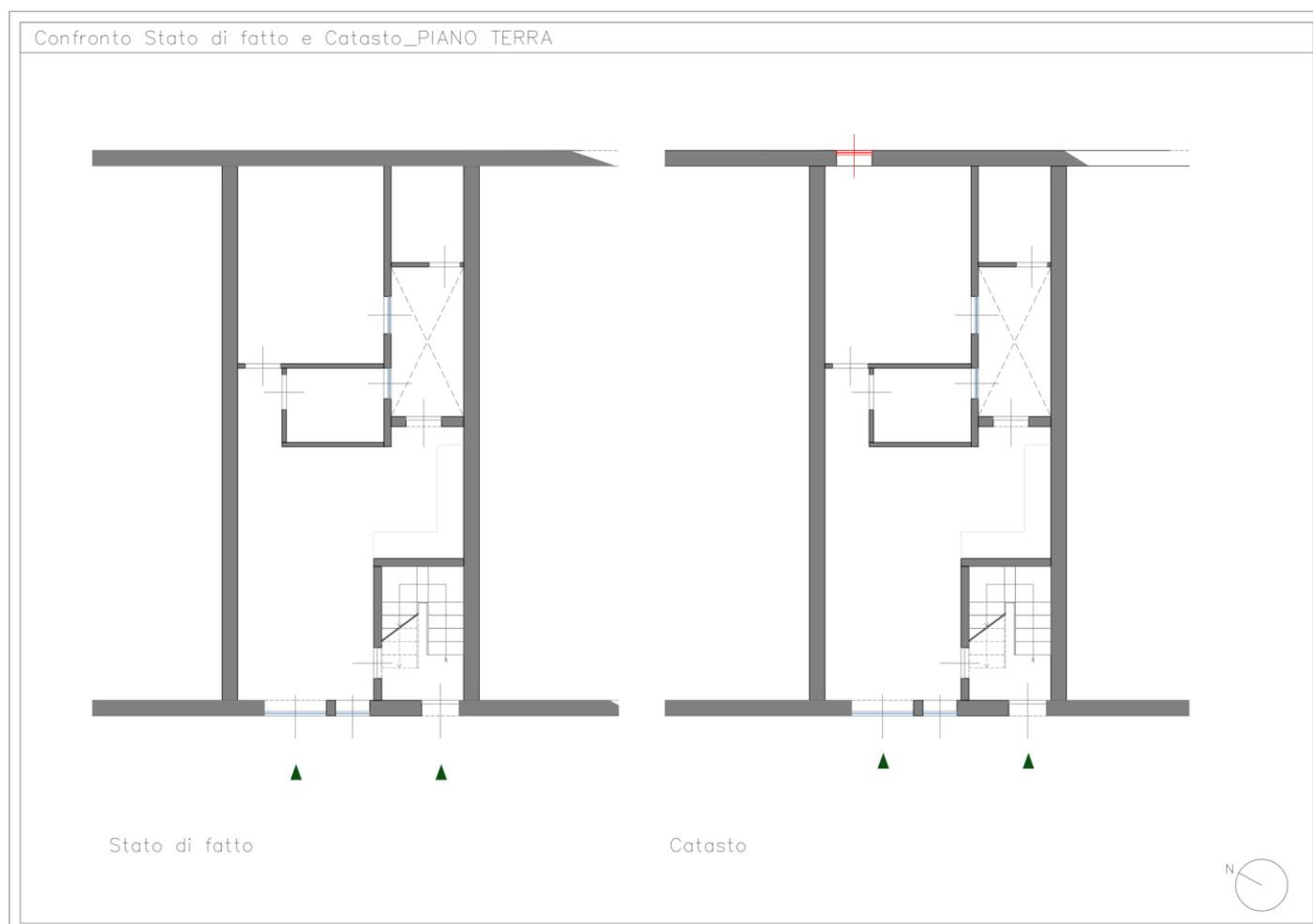
In particolare, sono state riscontrate le seguenti difformità catastali da sanare, rispetto la planimetria catastale depositata agli atti del catasto: - assenza di una finestra al piano terra nella camera matrimoniale come da stato di fatto rilevato, identificata invece nella planimetria catastale.
