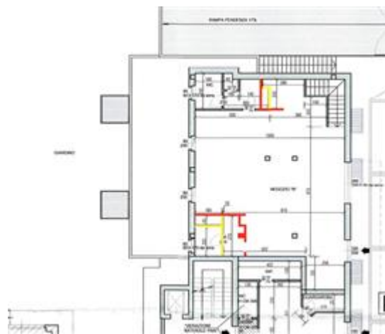
PIANTA PIANO TERRA CON INDICAZIONE SOMMARIA DELLE DIFFORMITA' (non in scala)
