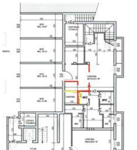
PIANTA PIANO INTERRATO CON INDICAZIONE SOMMARIA DELLE DIFFORMITA' (non in scala)
