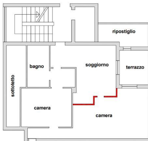
Elab. 2 – Evidenza dei tramezzi demoliti
