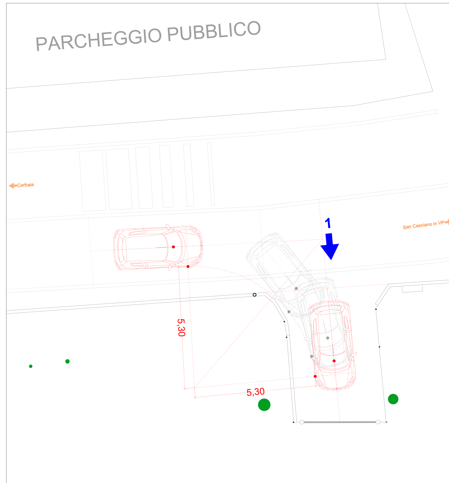
USCITA DALLA SP12 E MANOVRA DI INGRESSO NEL RESEDE PRINCIPALE PERTINENZIALE DEL COMPLESSO DI VILLA TALENTE
