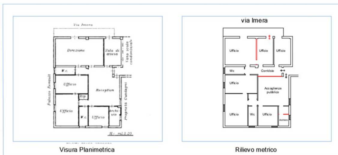
Figure 7 – Confronto tra la planimetrica catastale e la restituzione grafica dello stato di fatto: in rosso le difformità riscontrate
