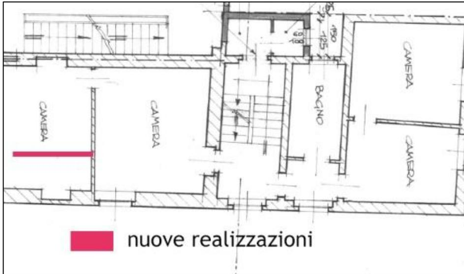
Inserimento di un tamponamento in muratura che divide la stanza in 2 locali
