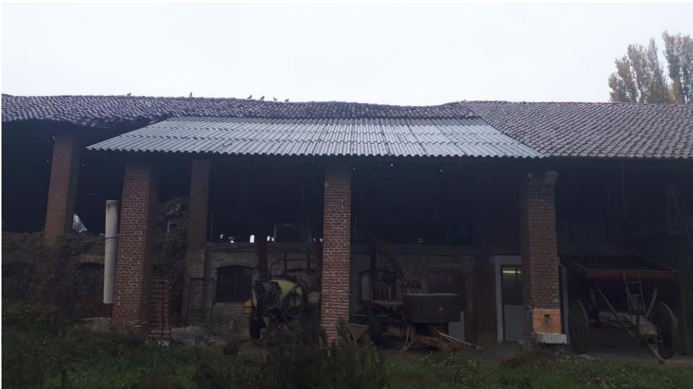
Fabbricato su due livelli oltre a porticato su ambo i fronti. Un porzione su due livelli con copertura in ordine al piano terra depositi e lavorazione riso e al P1 ex ufficio e silos. Altra porzione con magazzino al pt e cassero aperto al P1, copertura da sostituire con parziale bonifica di lastre in eternit.
