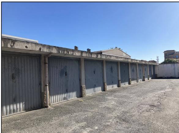
Ciascun box auto dispone di serramento in ferro basculante con semplice serratura. E' pavimentato in battuto di cemento e rifinito a parete in intonaco. Non sono presenti impianti.
