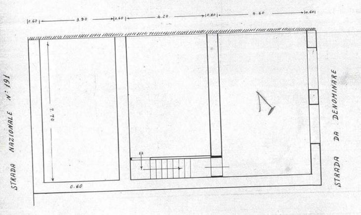
PIANTA DELLE FONDAMENTA E DEL PIANO SEMINTERRATO
