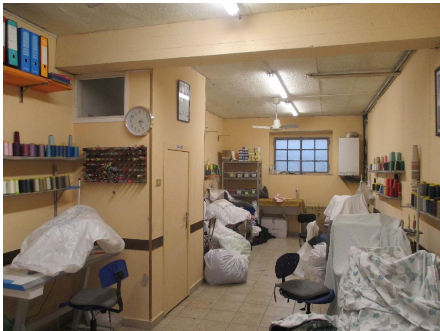
Foto n.4b: Particolare del laboratorio al piano terra, sulla sinistra è visibile il w.c. senza di areazione e luce dirette e privo di aereazione meccanica. Sulla destra in fondo è visibile la caldaia alimentata a metano in comune con l'appartamento al piano primo (Bene A)
