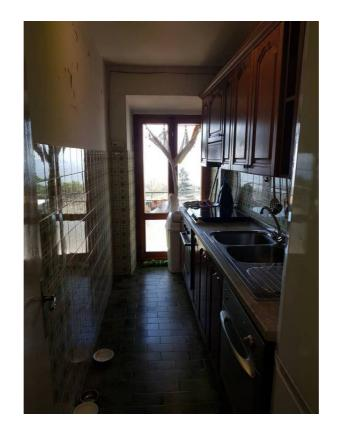
Non sono presenti le prescritte aperture di aerazione e di ventilazione di cui alla UNI 7129. Il locale è comunque aerabile mediante la finestra perimetrale ed, indirettamente, dagli infissi adiacente.
