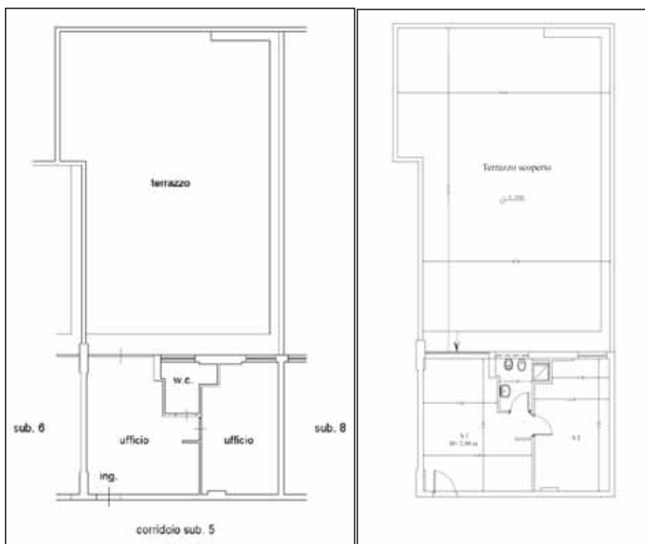
Fig. 5 – Confronto della Planimetria in atti al Catasto con lo stato dei luoghi - CONFORME
