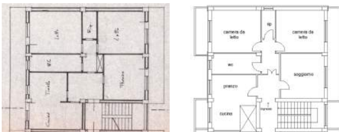
Fig. 32- Piano secondo sub 7 - Confronto tra la planimetria "assentita" e stato di fatto.
