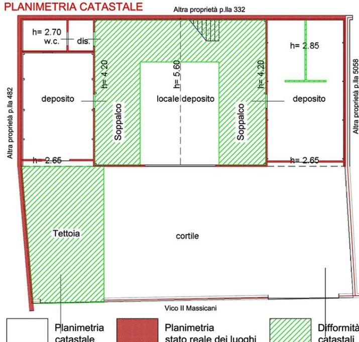
Con la sovrapposizione della planimetria dello stato reale dei luoghi con quella catastale del deposito, sono evidenti delle difformità relative alla presenza di una tettoia presso il cortile di 52.53mq, di un soppalco interno di 76.00mq e di una tramezzatura interna presso il deposito 3. Le difformità riscontrate possono essere sanate mediante presentazione di variazione catastale presso gli uffici catastali dell’Agenzia delle Entrate, con un costo di € 800,00
