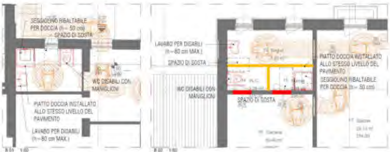
Figura 8 - Predisposizione Servizi Igienici
