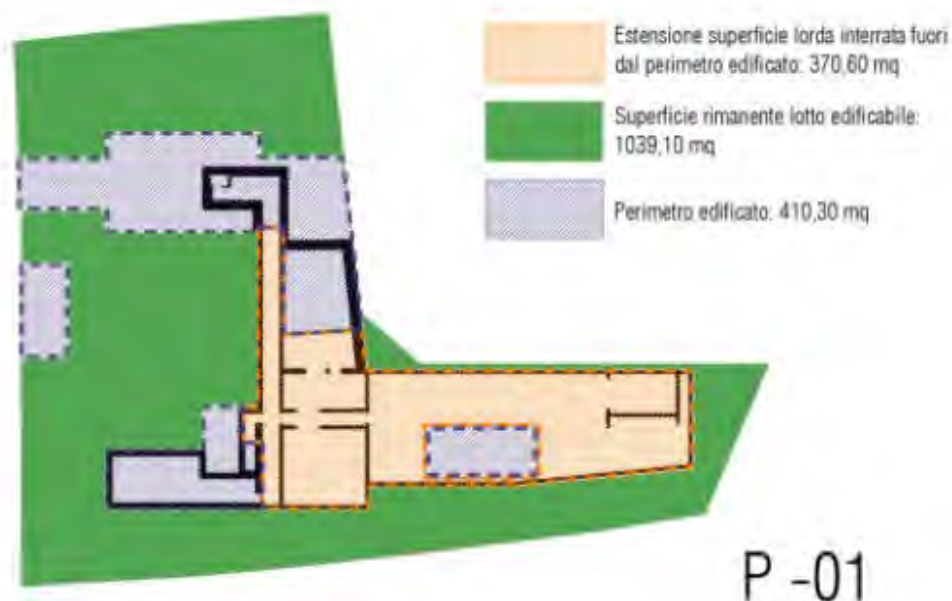
Figura 6 Art. 13 N.T.O. - Disciplina interventi edilizi - Costruzioni Interrate
