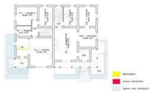
difformità edilizie piano terra
