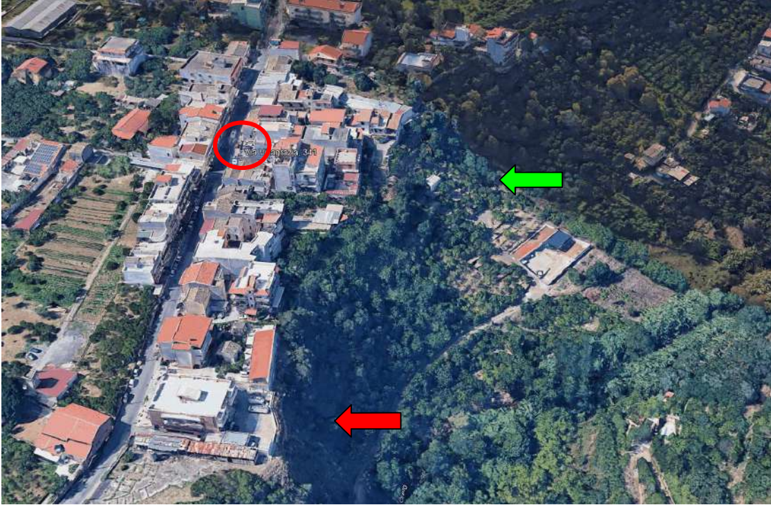
Fig 2.1: Schematizzazione dell'azione dell'erosione fluviale nei confronti delle pareti calcarenitiche, massima (in rosso) e praticamente inesistente (in verde) rispetto al nostro edificio.
