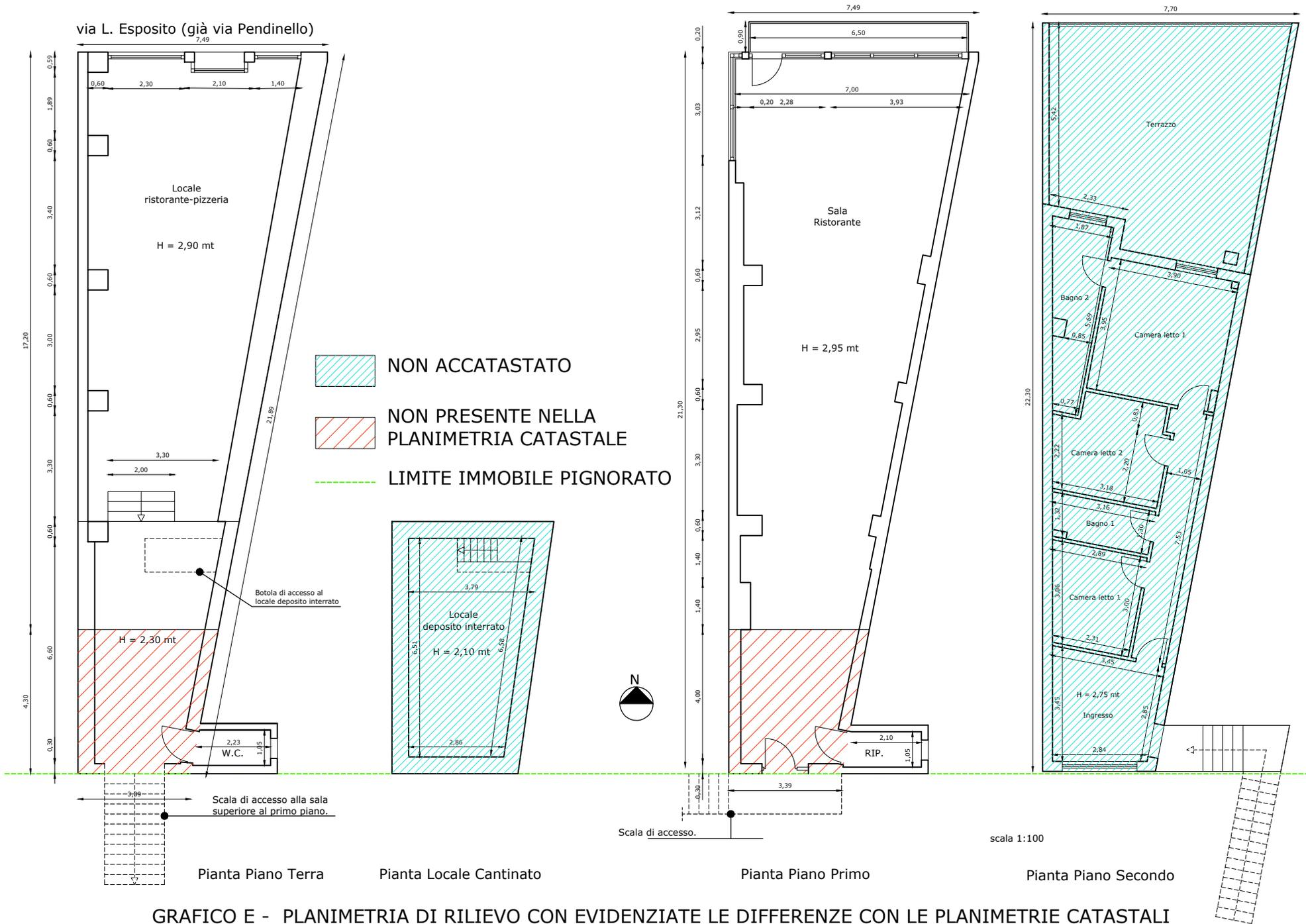
GRAFICO E - PLANIMETRIA DI RILIEVO CON EVIDENZIATE LE DIFFERENZE CON LE PLANIMETRIE CATASTALI
