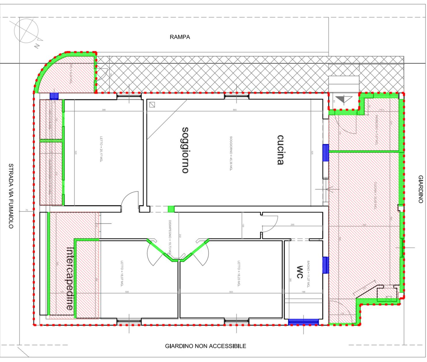
SOVRAPPOSIZIONE DELLA PLANIMETRIA CATASTALE CON LA PIANTA DI RILIEVO DELL'ESISTENTE ED INDIVIDUAZIONE DELLE DIFFORMITA' RICONTRATE
