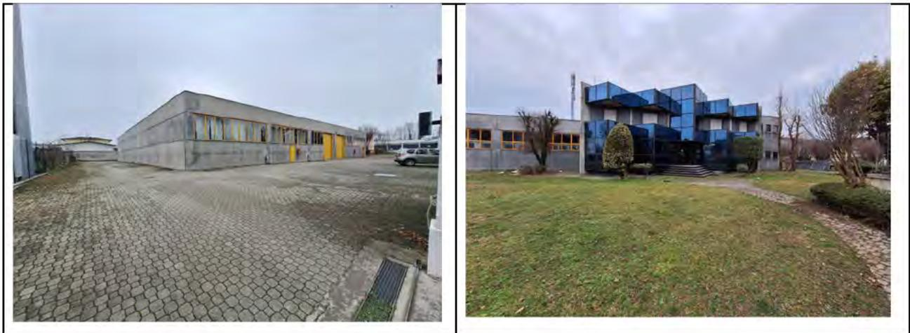
Il fabbricato presenta struttura portante in pilastri e travi in c.a. e solai misti in laterocemento per gli uffici e strutture prefabbricate per il capannone.
