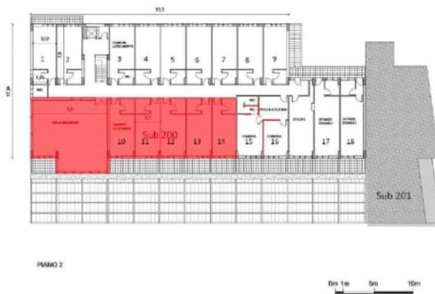
*Rilievo metrico dello stato di fatto con difformità riscontrate <sup>12</sup>*
