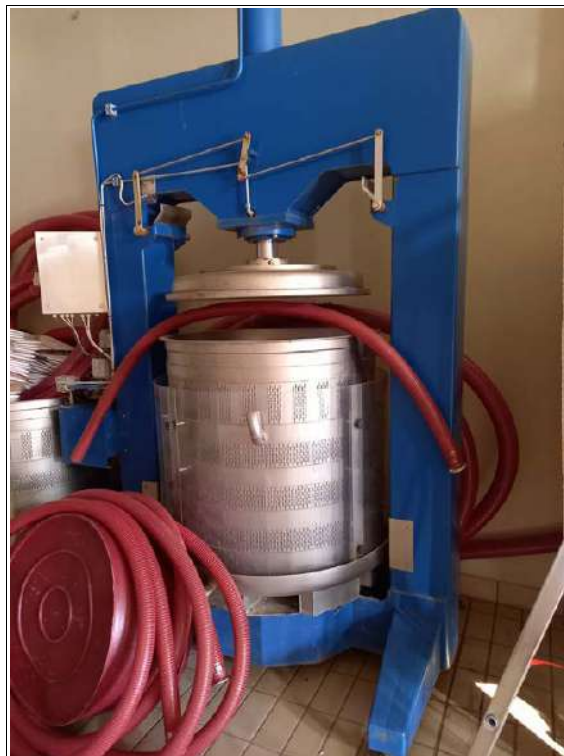
FOTO 14 - Torchio idraulico, marca Mori, con 2 gabbie
