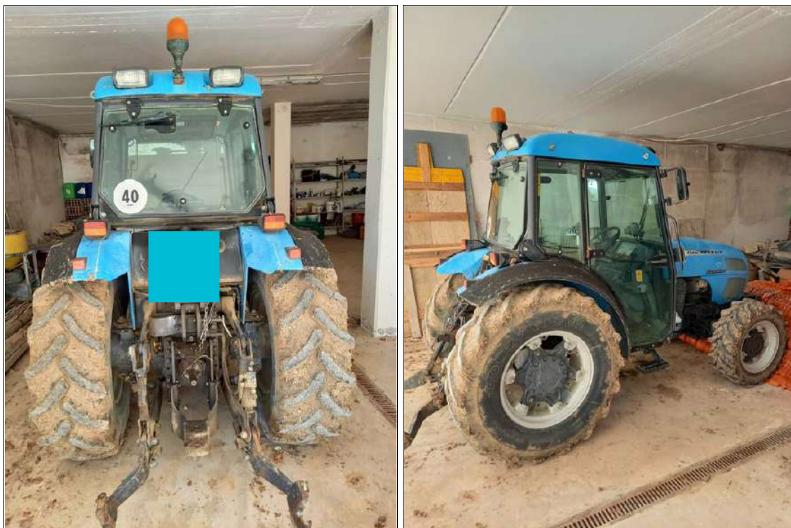
FOTO 1-2 – Trattore Landini Rex 90 GT, 4.r.m., targa AN808Z, 2.822 ore di lavoro.
