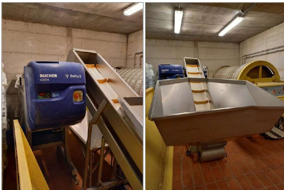
FOTO 5-6 – Pigiadiraspatrice Bucher-Vaslin, mod. Delta E2, con tramoggia di carico superiore
