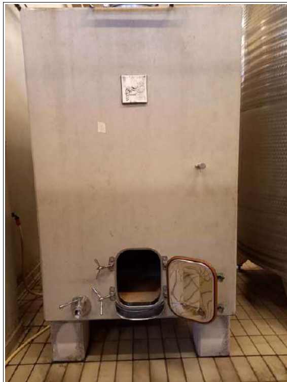
FOTO 9-10 – A sinistra: impianto refrigerazione cantina con doppio motore/inverter, marca Climaveneta; a destra: vasca in cemento e resina, amovibile, 44 HI, marca Nico Velo.
