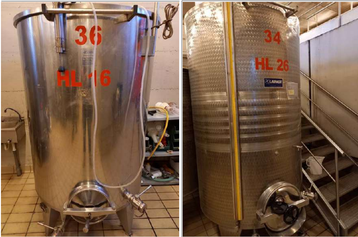
FOTO 22-23 – A sinistra: serbatoio in acciaio inox, 16 Hl, sempre pieno. A destra: serbatoio in acciaio inox, 26 Hl, termo condizionato, marca Lainox
