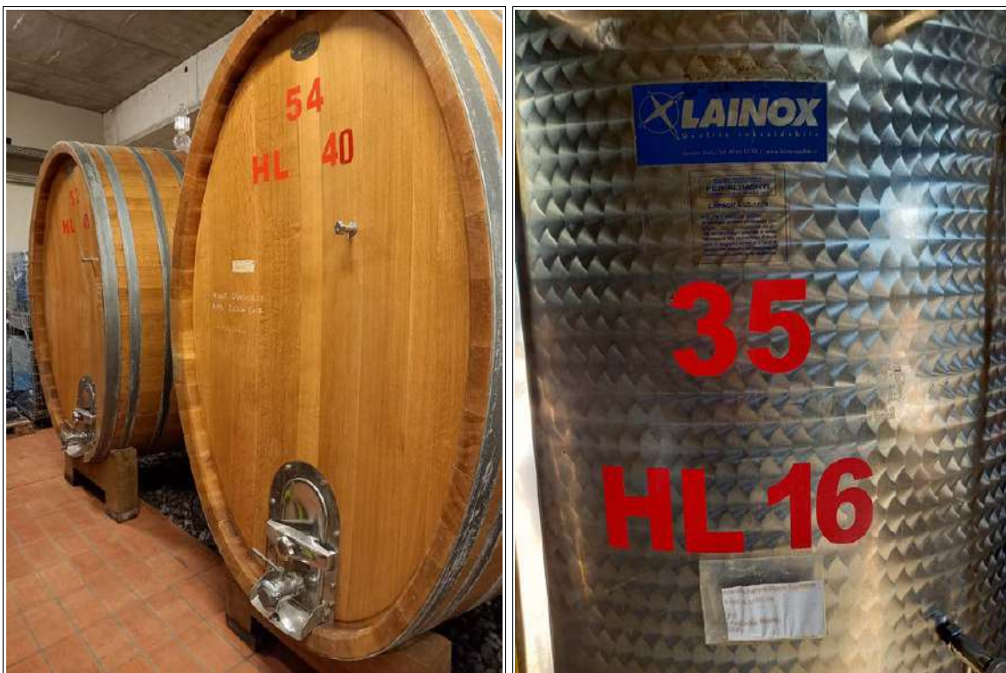
FOTO 17-18 – A sinistra: botti in legno da 40 HL, rovere francese, marca Pauscha; a destra: serbatoio in acciaio inox, 26 HL, termo condizionato, marca Lainox.
