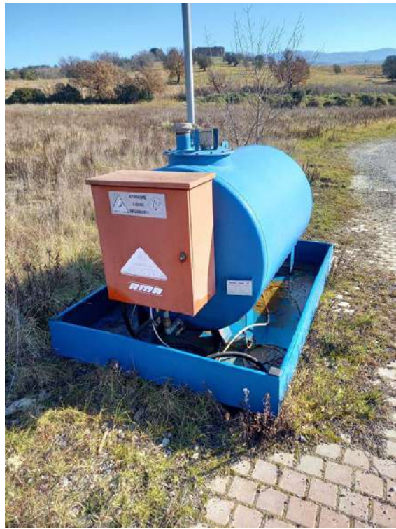
FOTO 7-8 – A sinistra: pressa orizzontale a piatti, marca Vaslin, mod. Veritas 22 (22 HI) a destra: serbatoio per gasolio agricolo, marca AMA, 1500 Lt, con pompa elettrica.
