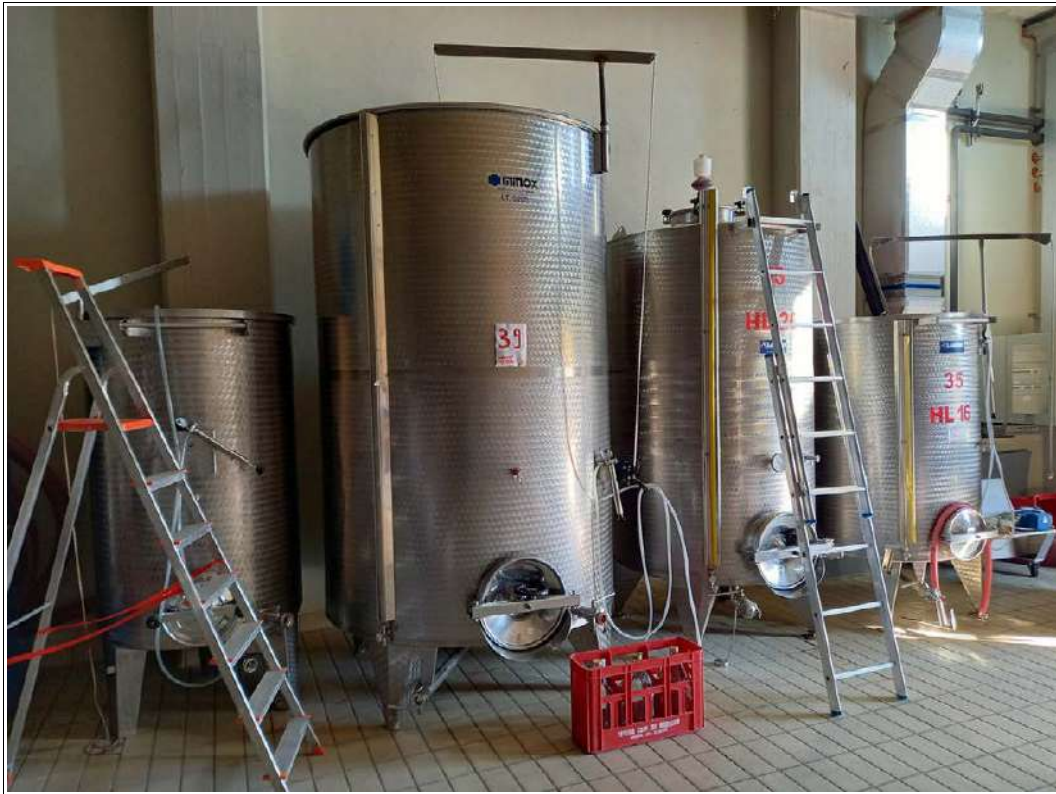
FOTO 13 – N. 4 serbatoi inox stoccaggio vino varie dimensioni (10-16-50 HL sempre pieno, 26 HI termo condizionato), nel magazzino prodotti della cantina.
